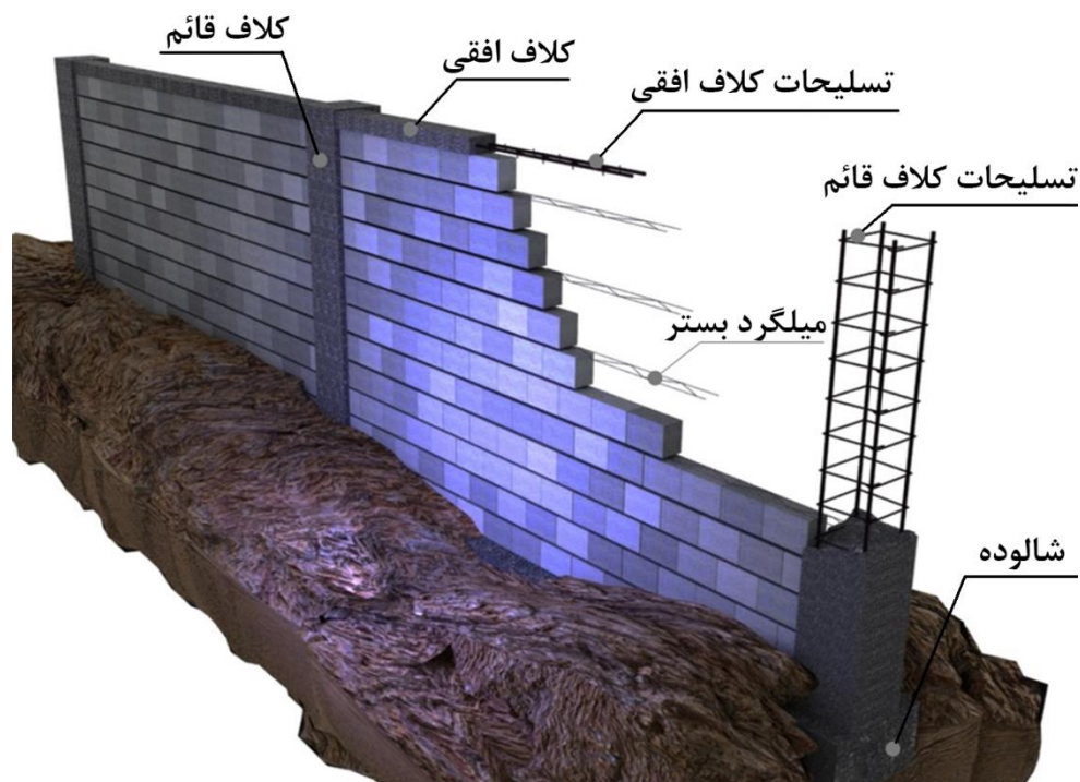
شکل ۱-۲ قسمت‌های اصلی دیوارهای محوطه بنایی
