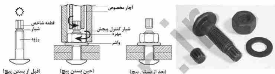
شکل ۱۰-۴-۵: پیچ کشش-کنترل (TC Bolt)
