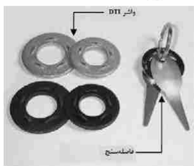
شکل ۱۰-۴-۷: فاصله قابل مشاهده در روش DTI پس از پیش‌تنیده کردن
