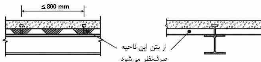
شکل ۲-۱۰-۸-۸: عرشه فولادی که کنگره‌های آن عمود بر محور طولی تیر است
